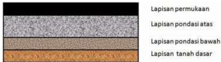
Gambar 2.2 Susunan Lapisan Konstruksi Perkerasan Jalan Sumber : internet (2021)
