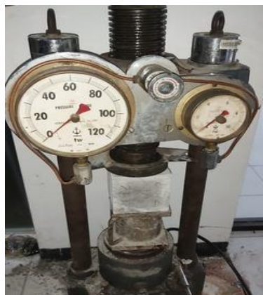
Gambar 3.6 Alat Uji Kuat Tekan Beton Sumber : Dokumentasi Lapangan (2021)
