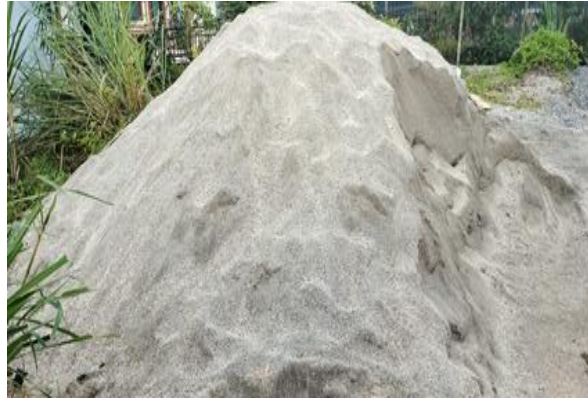
Gambar 2.2 Agregat Halus Sumber : Dokumentasi Lapangan (2021)
