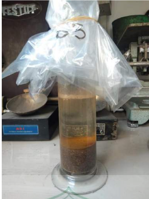
Gambar 4.2 Pemeriksaan Zat organic Agregat halus
