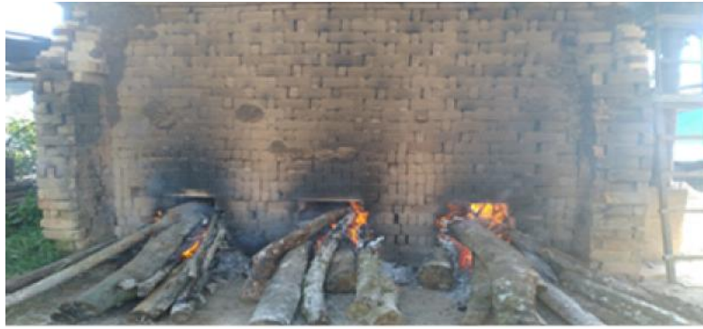
Gambar 4.4 Pembakaran batu bata
