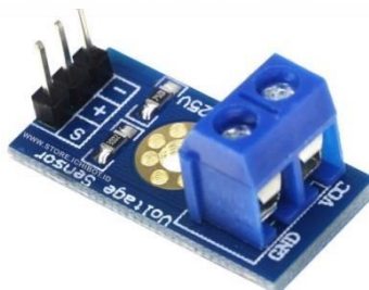
Gambar 2.6. Sensor Tegangan Sumber: store.ichibot.id(2022)
