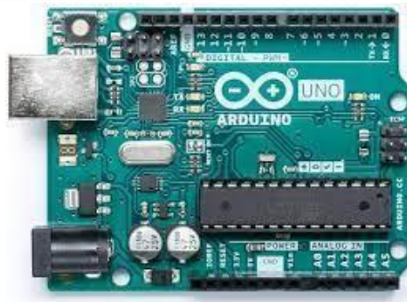
Gambar 2.2. Mikrokontroler Arduino Uno Sumber: arduinoindonesia.id (2021)
