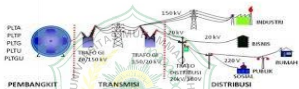
Gambar 2.1 Pembangkit tenaga listrik dan penyalurannya
