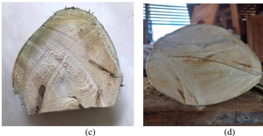
Gambar 1. Sampel Uji Makroskopis
