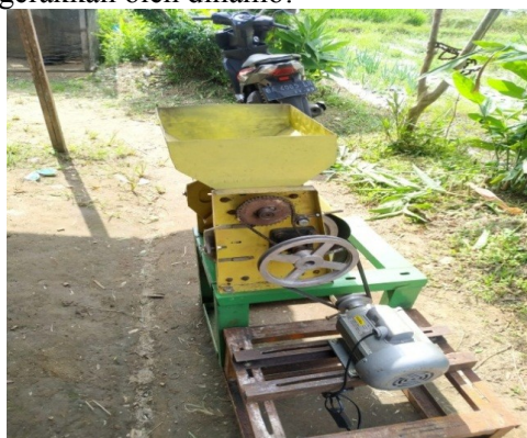
Gambar 8. Mesin pengupas kulit kopi basah
