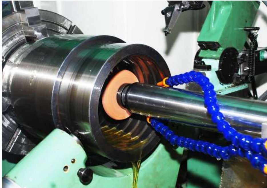
Gambar 6.4. Proses gerinda dalam/ internal
