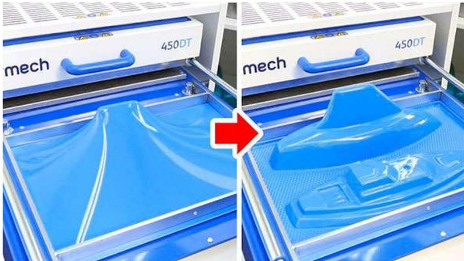
**Gambar 8.10.** Proses pencetakan dengan Vakum Forming
