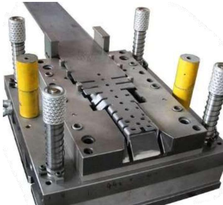
**Gambar 9.14.** Alat pemotong/ cetakan / stamping die
