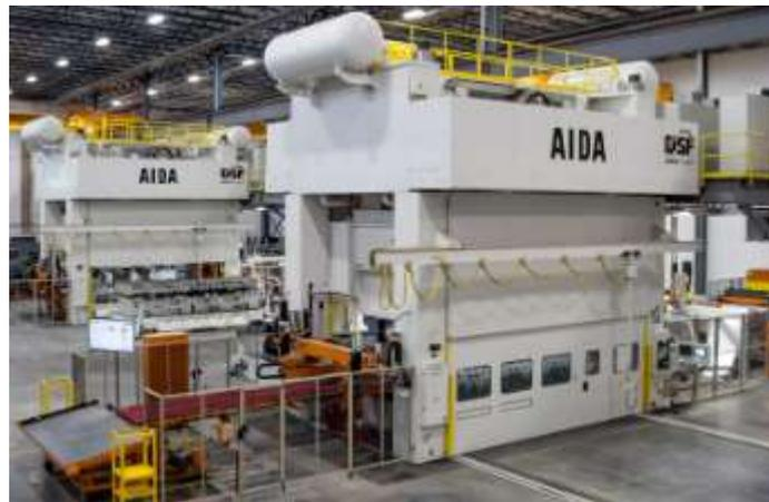
**Gambar 9.16.** Mesin press kapasitas besar yang biasa digunakan untuk pembentukan body mobil
