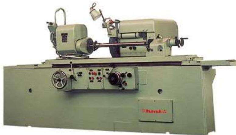
**Gambar 6.1.** Mesin gerinda silindris
