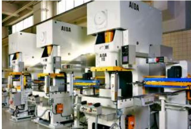
**Gambar 9.15.** Mesin press kapasitas kecil yang bisa dipasang dan bekerja secara tandem/ berkesinambungan.
