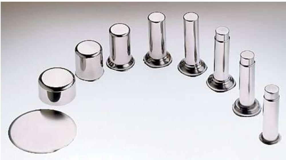
**Gambar 9.13.** Contoh tahapan proses pembentukan produk *Deep Drawing*, dimulai dari material awal berupa hasil *blanking* (kiri) hingga produk jadi berupa tabung stainless dengan diameter yang semakin kecil dan panjang.
