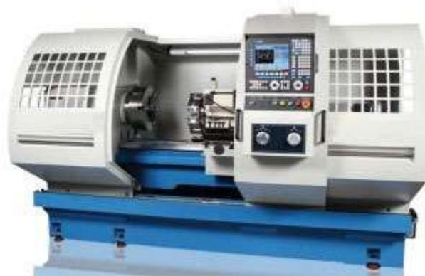
**Gambar 7.1.** Mesin CNC Bubut
