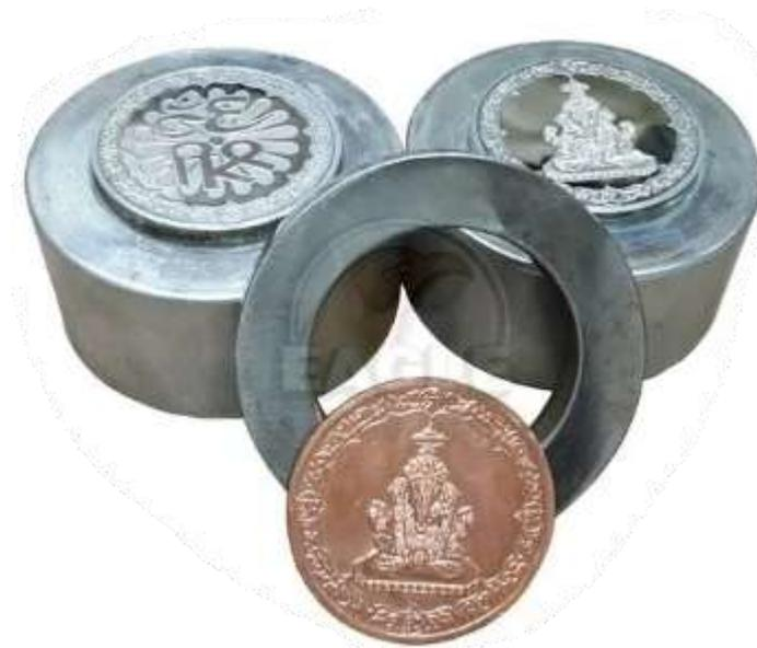
**Gambar 9.11.** Cetakan dan produk hasil proses *Coining*
