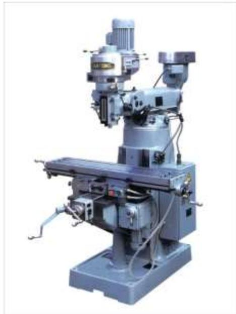
**Gambar 4.5.** Mesin Frais Vertikal
