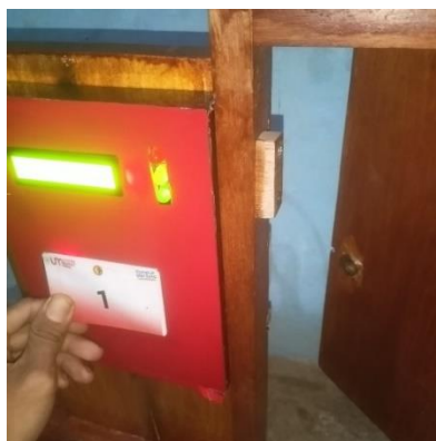
Gambar 4.9 Pintu Terbuka Dengan Kartu RFID Yang Sudah Terdaftar
