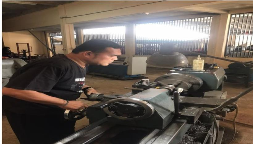
Gambar 3.17 Proses pembubutan *Bushing* dudukan mata pencacah
