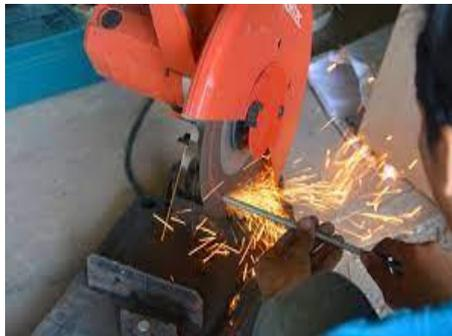
Gambar 3.14 Pemotongan Besi Siku dan pembuatan rangka
