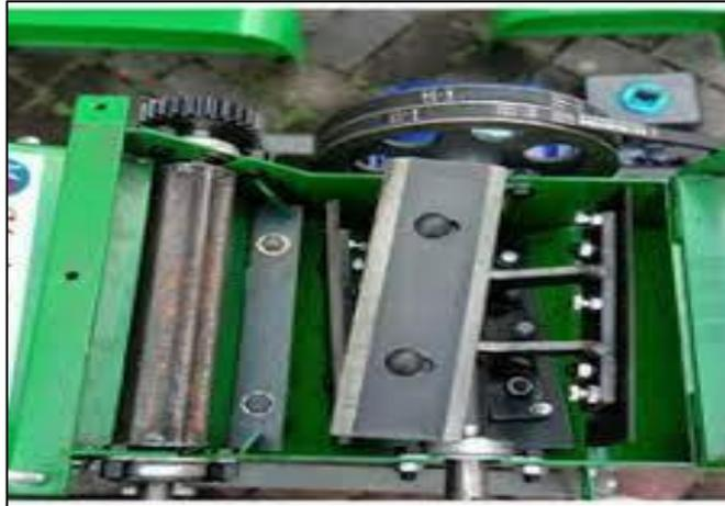
**Gambar 2.7** Mesin Pencacah Putar (*Rotary Shredder*)[10]
