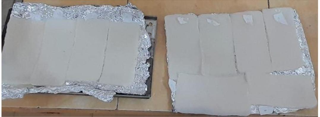
4. Proses pengeringan menggunakan oven selama 3 jam dengan temperatur 105°C.
