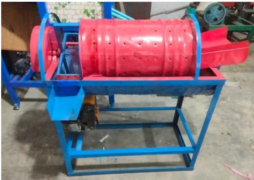
Gambar 4. 1 Mesin Pencuci Jahe Sumber : Dokumentasi Pribadi
