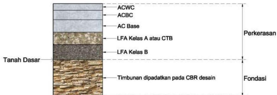
Gambar 2.3 Struktur perkerasan lentur pada tanah timbunan
