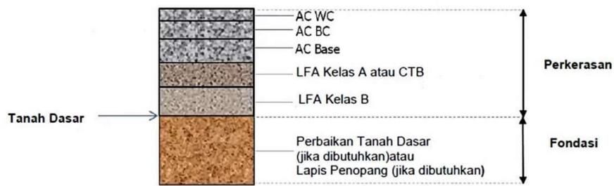
Gambar 2.2 Struktur perkerasan lentur pada tanah asli
