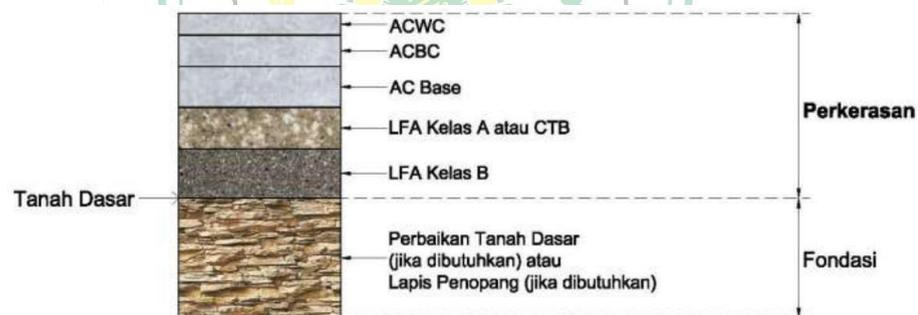
Gambar 2.4 Struktur perkerasan lentur pada tanah galian
