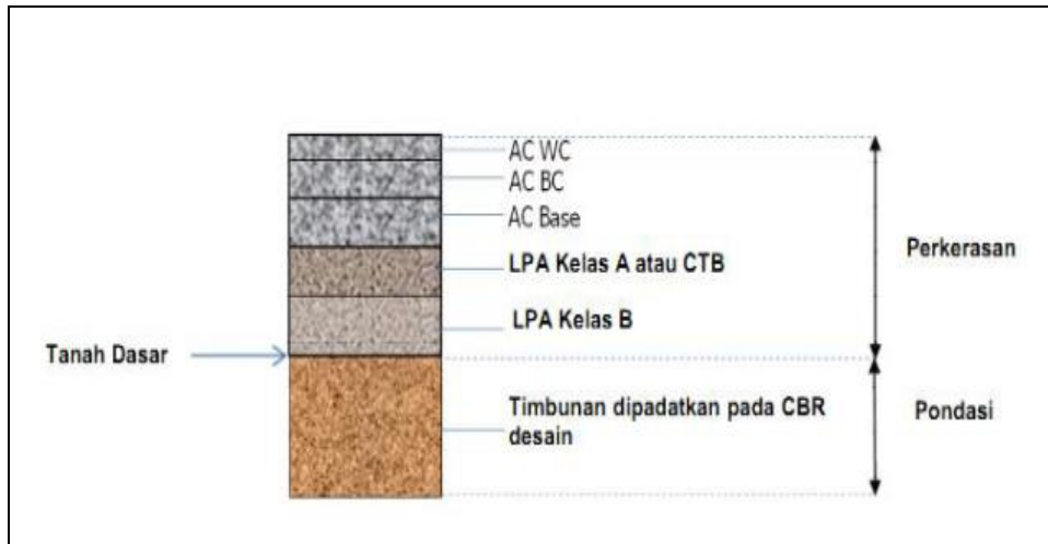
Gambar 2.2 Perkerasan Lentur pada Tanah Timbunan
