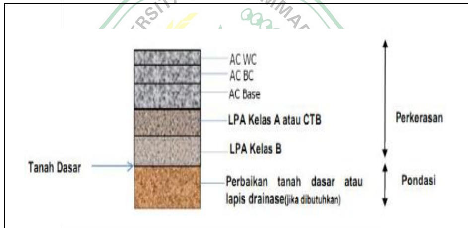
Gambar 2.3 Perkerasan Lentur pada Daerah Galian
