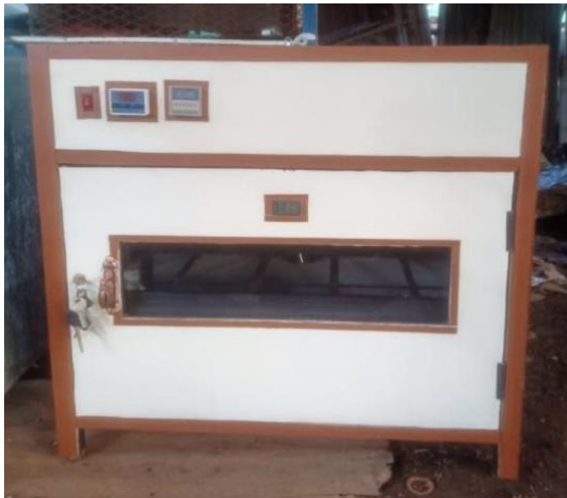
Gambar 2. Mesin penetas telur
