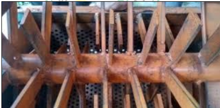
Gambar 2.3 Desain mata potong pada peneliti sebelumnya dengan mata potong persegi[9]
