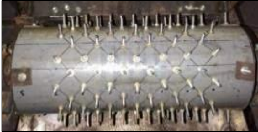
Gambar 2.4 Desain mata potong dengan penggunaan baut dalam mesin pembuat cocopeat [10]
