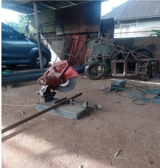
**Gambar 3.7** proses pemotongan baja hollow
