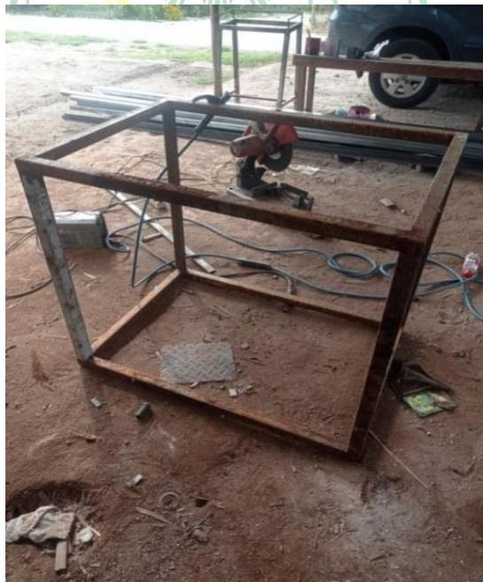
**Gambar 3.8** rangka alat penetas telur otomatis
