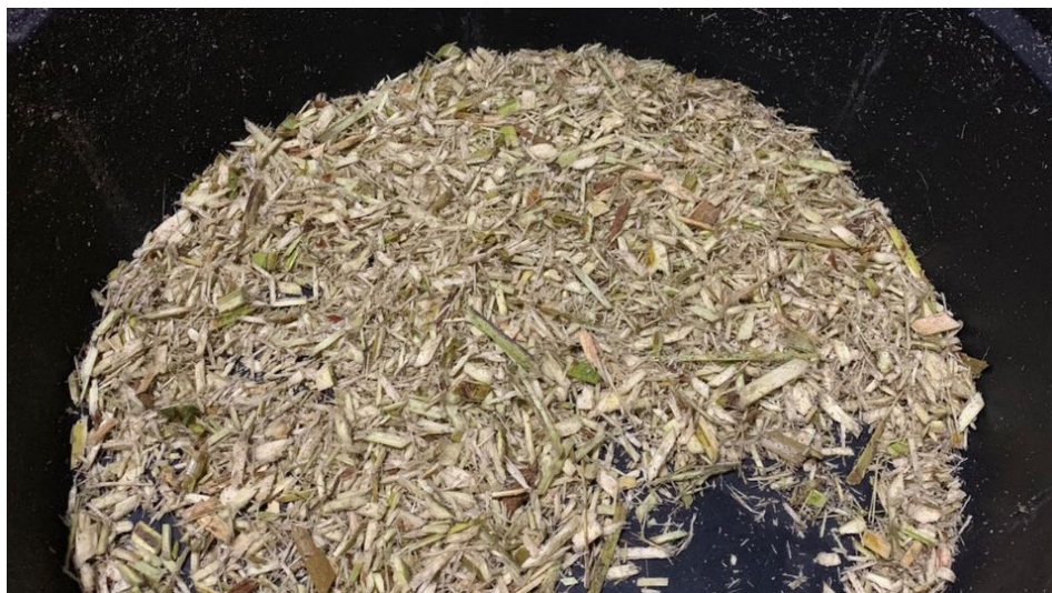
Gambar 4.3 Hasil cacahan pelepah kelapa muda yang halus pada putaran tinggi
