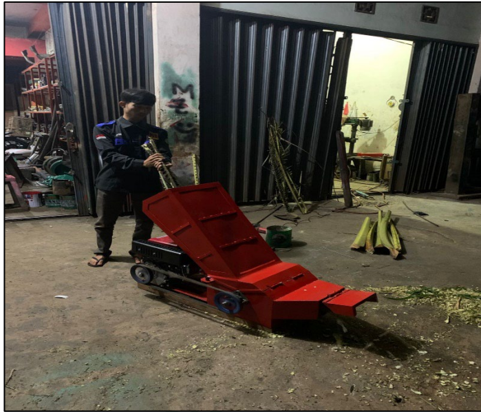
Gambar 3.11. Memasukan pelepah ke mesin pencacah
