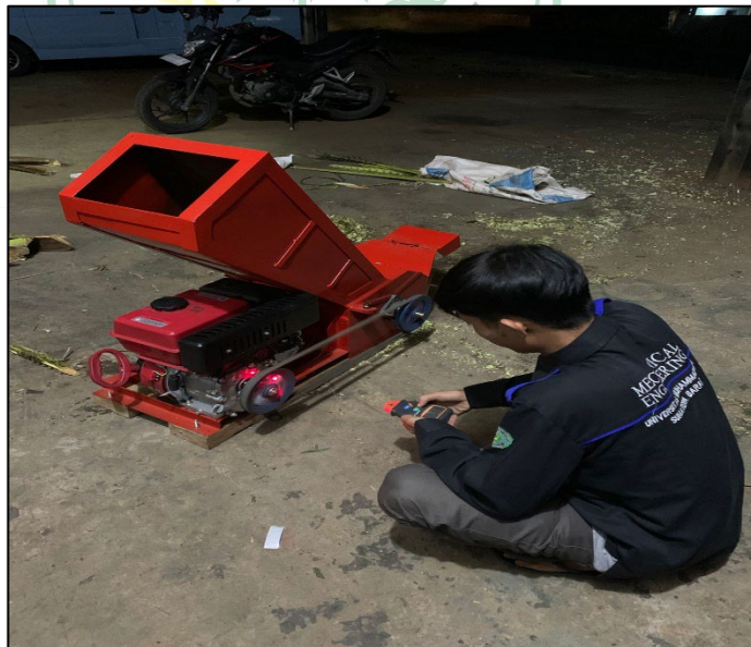
Gambar 3.10. Menghidupkan mesin dan mengecek putaran mesin
