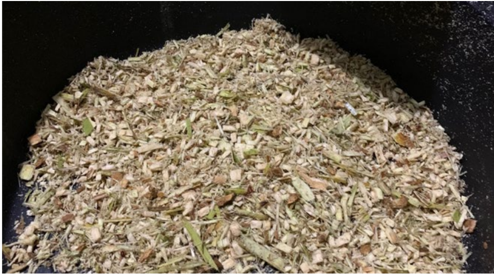
Gambar 4.6 Hasil cacahan pelepah kelapa setengah tua yang halus pada putaran tinggi
