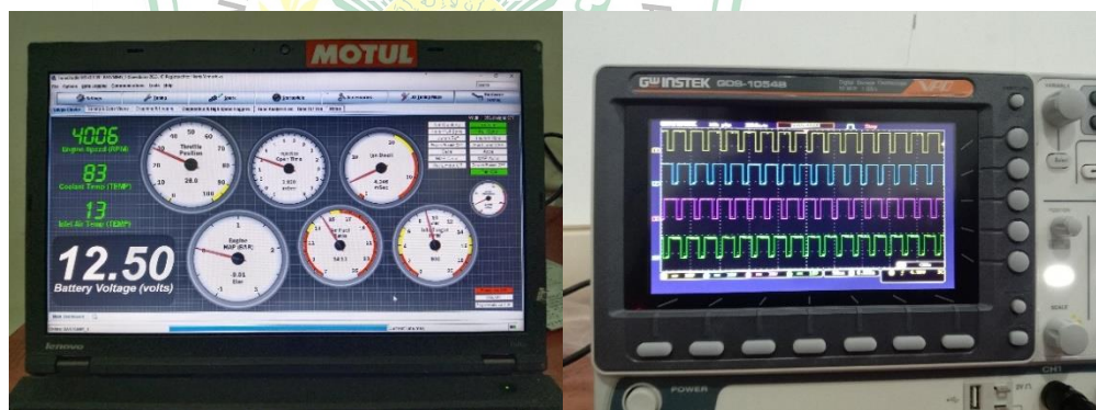
Gambar 4.28 Hasil pengujian penyemprotan injektor 1, 2, 3 dan 4 pada 4000 rpm
