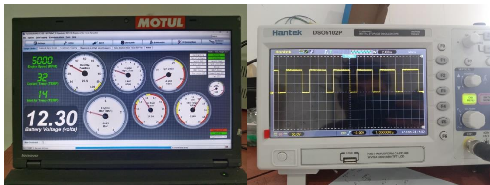
Gambar 4.31 Hasil pengujian waktu pengapian pada 5000 rpm
