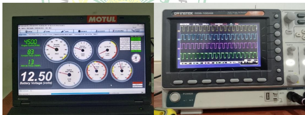
Gambar 4.30 Hasil pengujian penyemprotan injektor 1, 2, 3 dan 4 pada 4500 rpm
