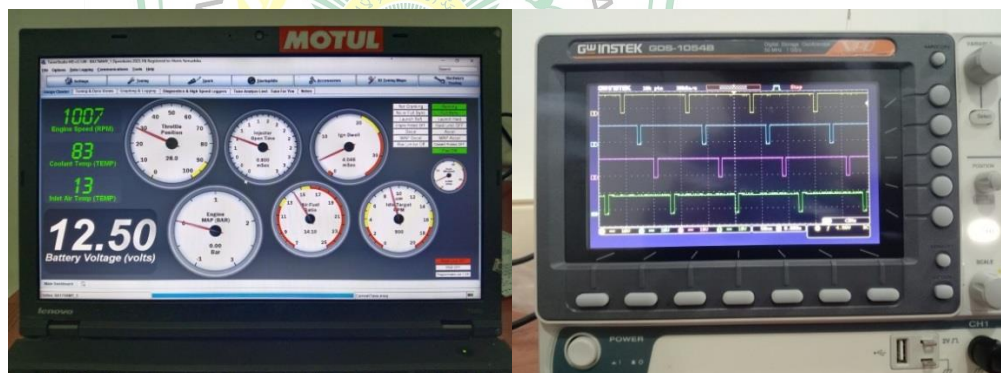
Gambar 4.16 Hasil pengujian penyemprotan injektor 1, 2, 3 dan 4 pada 1000 rpm
