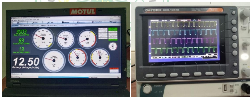
Gambar 4.24 Hasil pengujian penyemprotan injektor 1, 2, 3 dan 4 pada 3000 rpm
