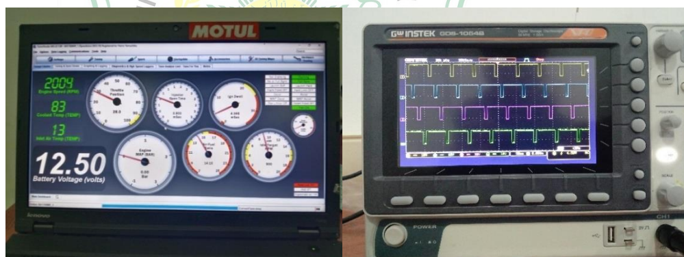
Gambar 4.20 Hasil pengujian penyemprotan injektor 1, 2, 3 dan 4 pada 2000 rpm
