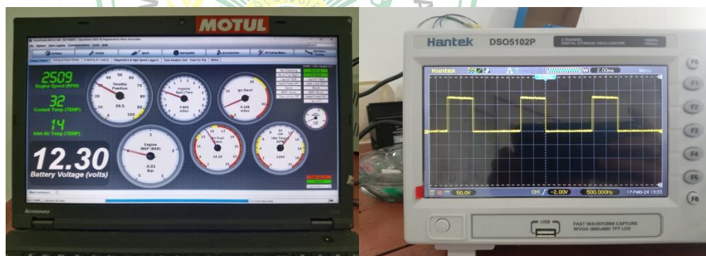
Gambar 4.22 Hasil pengujian penyemprotan injektor 1, 2, 3 dan 4 pada 2500 rpm
