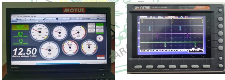
Gambar 4.14 Hasil pengujian penyemprotan injektor 1, 2, 3 dan 4 pada 500 rpm
