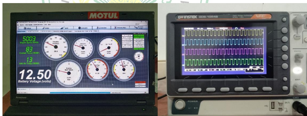
Gambar 4.32 Hasil pengujian penyemprotan injektor 1, 2, 3 dan 4 pada 5000 rpm
