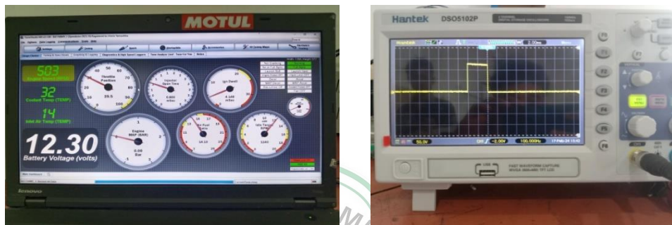
Gambar 4.13 Hasil pengujian waktu pengapian pada 500 rpm
