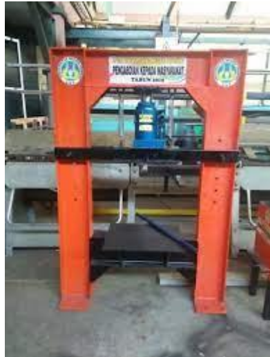
Gambar 2.11 Alat pres hidrolis manual gambir
