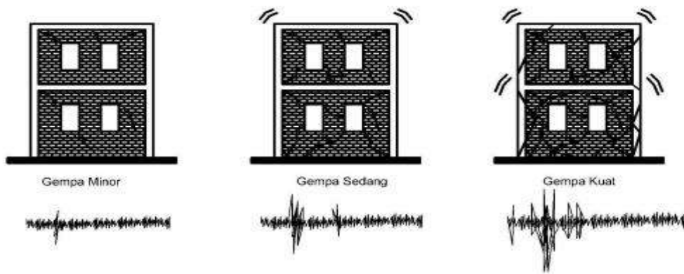
Gambar 2.1 Level-level kerusakan bangunan (Pawirodikromo, W., 2012)
