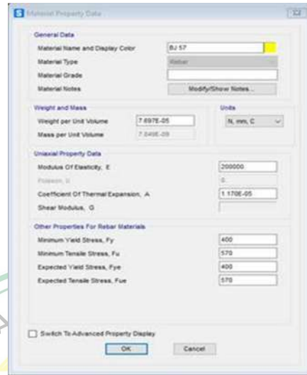
Gambar 2.24 Input Data Material Tulangan longitudinal
