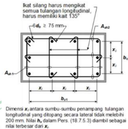
Gambar 2.10 Contoh penulangan transversal pada kolom dengan P_u > 0,3Agf_c' atau f_c' > 70 Mpa Sumber : SNI 2847:2019 gambar R18.7.5.2 f
