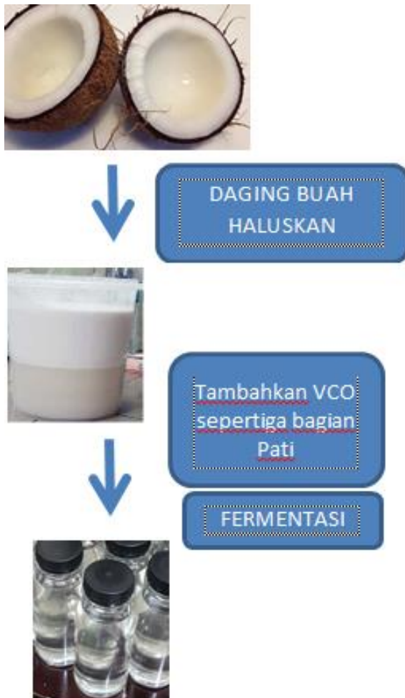
Gambar 16. Pembuatan VCO dengan cara Pancingan
