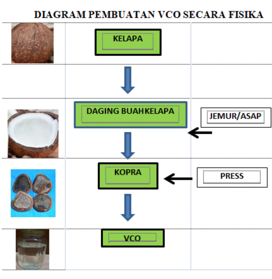
Gambar 15. Cara pembuatan VCO secara fisika.
