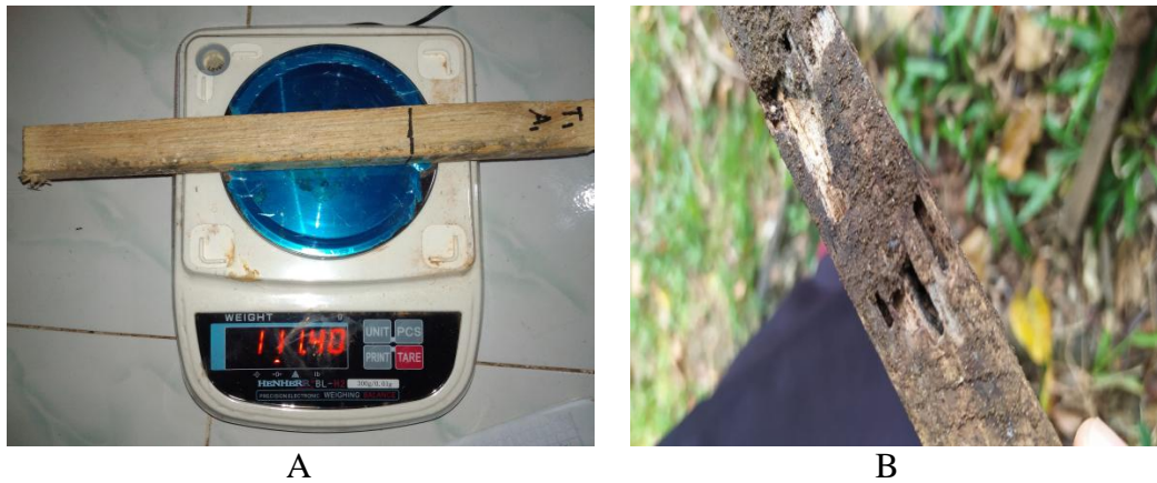
Gambar 26. Kondisi umpan uji grave yard test sebelum ditanam (a) dan sesudah pengujian (b).
