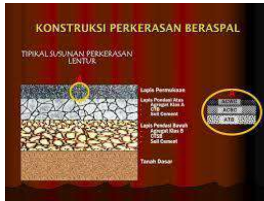
Gambar 2.2 Susunan Lapisan Perkerasan Lentur
