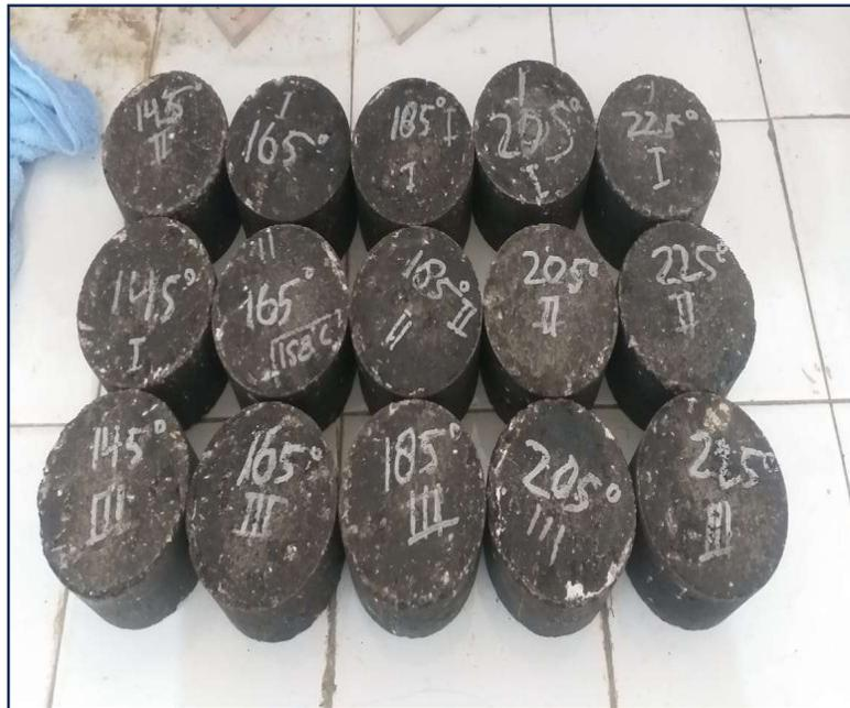
**Gambar 5.** Hasil Agregat Campuran AKAP
