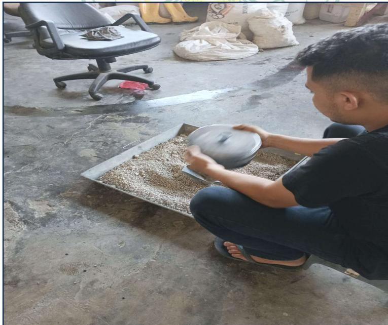
**Gambar 2.** Penyaringan Agregat
