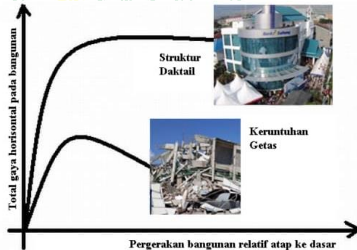
Gambar 2.6 Struktur Daktil dan Struktur Getas Gedung Kantor pusat Bank Sulteng dan Hotel Roa Roa di Palu Sumber : (Goggle, 13 Februari 2024)
