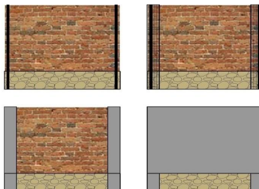
Gambar 2.19 Proses perkuatan kolom Sumber: (Nusantoro, 2012)
