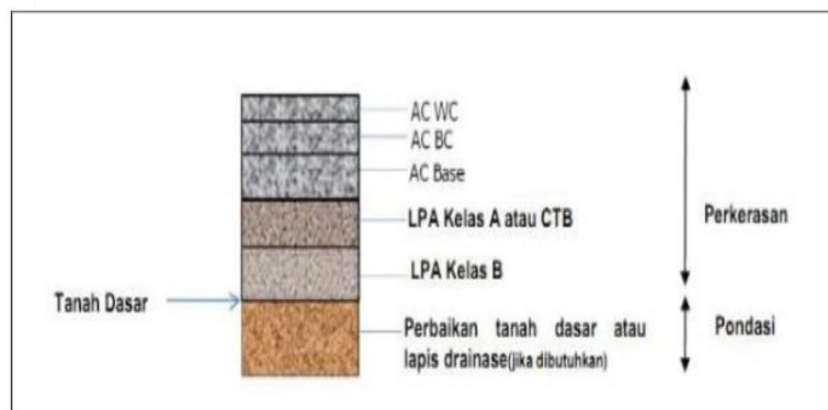
Gambar 2. 3 Perkerasan Lentur pada Daerah Galian
