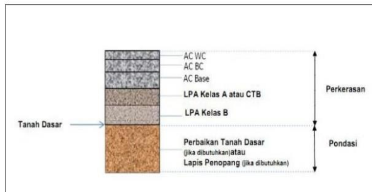
Gambar 2. 1 Perkerasan Lentur pada Permukaan Tanah Asli
