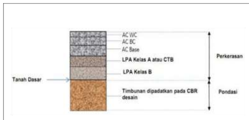
Gambar 2. 2 Perkerasan Lentur Pada Daerah Timbunan
