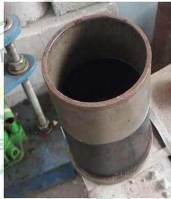
Gambar 3.8 Cetakan Benda Uji
