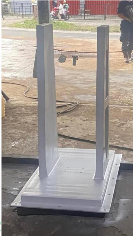
**Gambar 3.3** Rangka Alat Uji *Impact*
