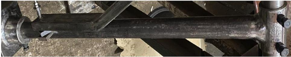
**Gambar 3.7** Poros, *bearing*, lengan pengayun dan pendulum
