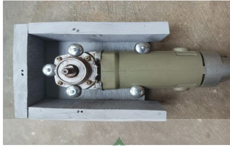
Gambar 3. 16 Pemasangan Rangka Ke Mesin
