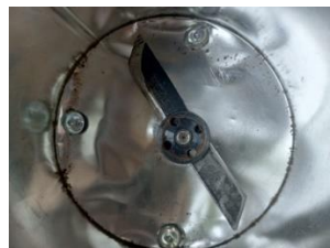
Gambar 3. 18 Pemasangan Mata Pisau
