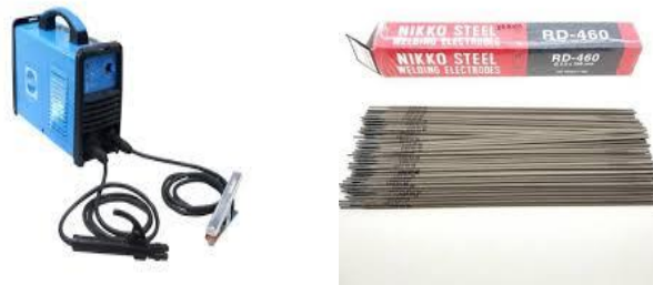
Gambar 3.6 Mesin las listrik dan elektroda
