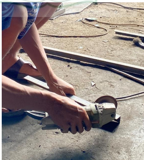
Gambar 3.13. Pemotongan material rangka
