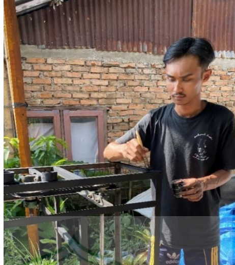
Gambar 3.16 Proses pengecatan rangka
