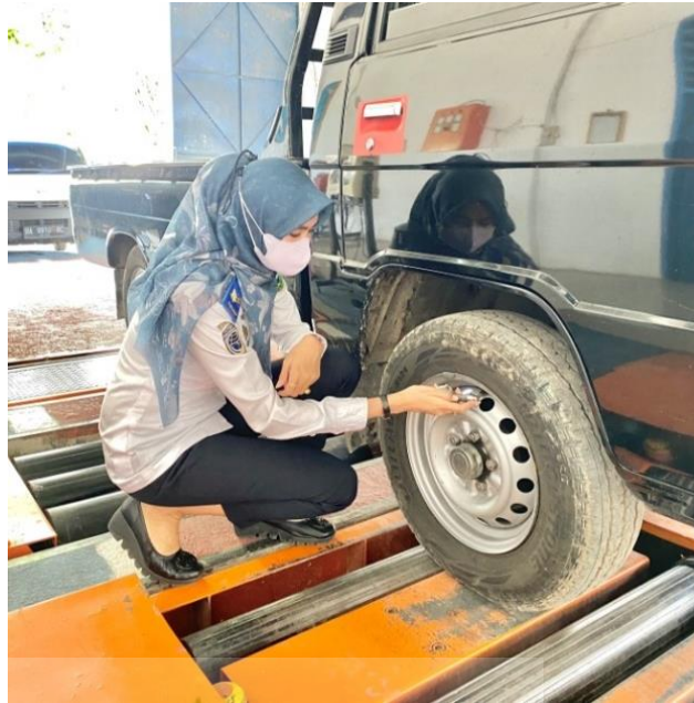
Gambar 3.7 Proses pengukuran tekanan angin ban sumbu 1
