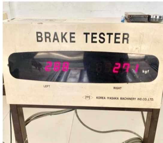
Gambar 3.9 Display hasil uji brake tester
