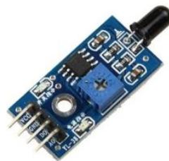
Gambar 2.6 Bentuk fisik flame sensor
