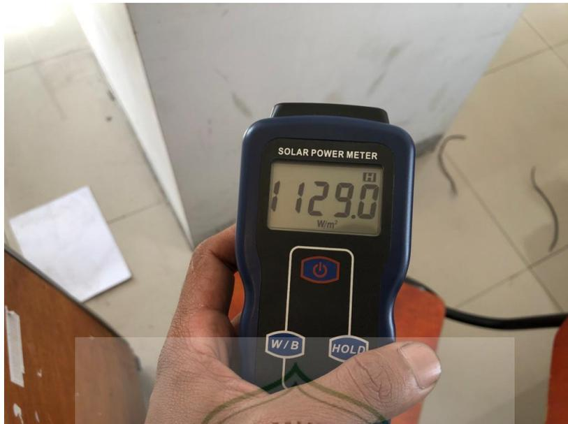
Gambar hasil pengukuran Solar Power Meter pada saat mendung.
