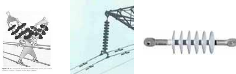
gambar 8: Jenis-jenis Isolator pada Saluran Transmisi
