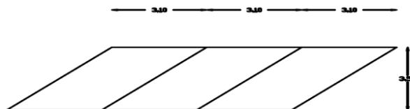
Gambar 4.4 Parkir Sudut  $45^\circ$  Kendaraan Roda Empat di Jalan Niaga
