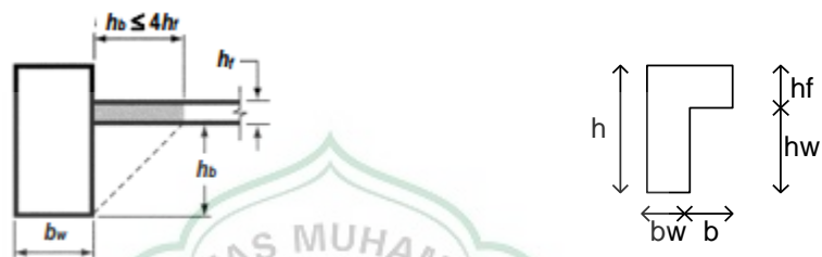
Gambar 4.4 Plat Tepi Konstruksi (Sumber : google Image Pelat)
