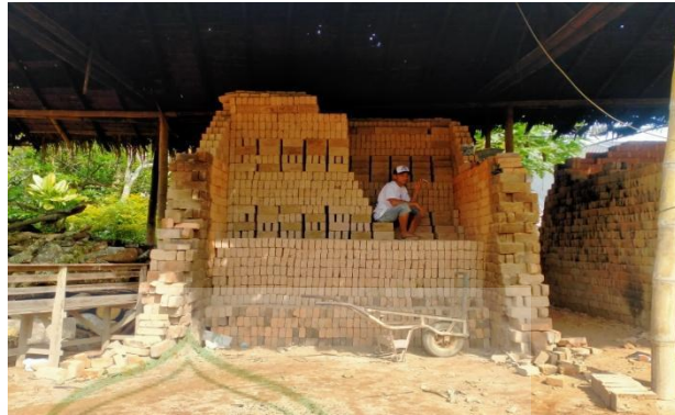
Gambar 4.8 Proses Pembakaran Batu Bata Merah
