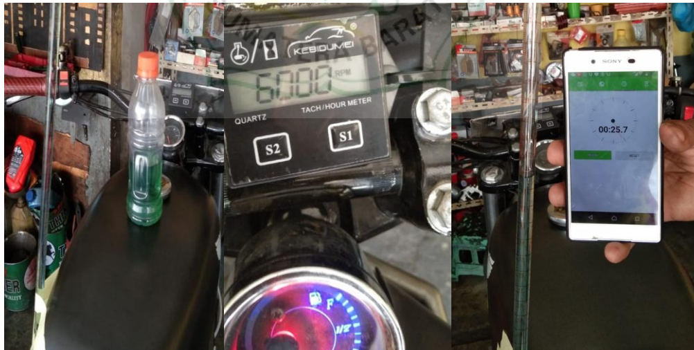
Gambar 3.17 Proses penghitungan konsumsi bahan bakar
