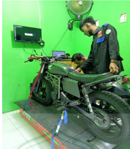
Gambar 3.16 Proses penghitungan daya dan torsi dengan dyno tes
