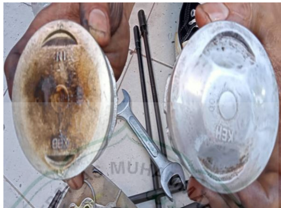
Gambar 2.4 Piston datar dan cembung
