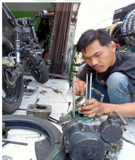
Gambar 3.15 Proses penggantian piston
