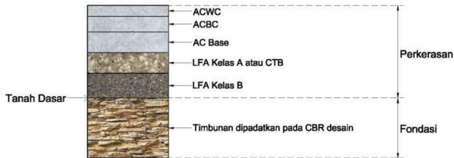
Gambar 2.3 Struktur perkerasan lentur pada tanah timbunan
