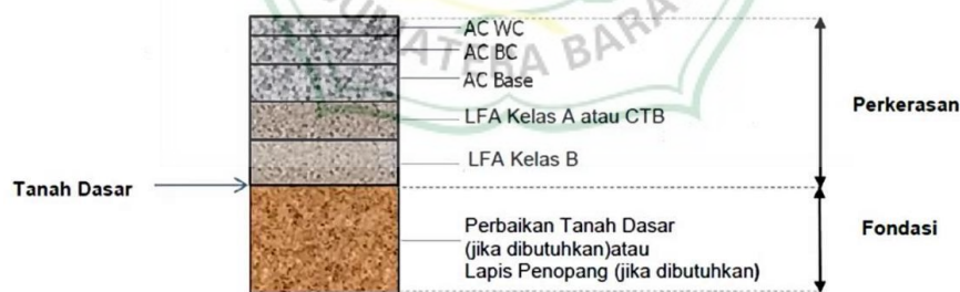
Gambar 2.2 Struktur perkerasan lentur pada tanah asli
