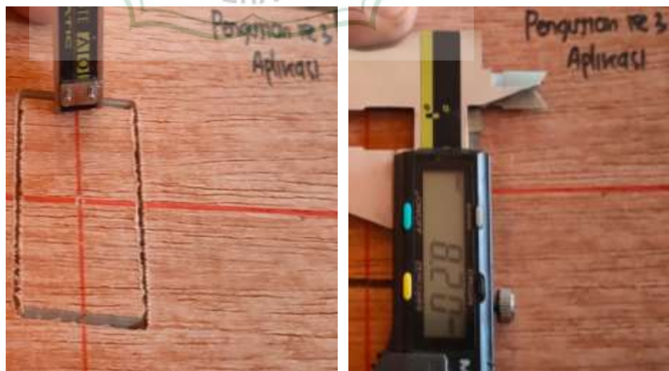
Gambar 4.15 Pengukuran hasil grafir sumbu Z
