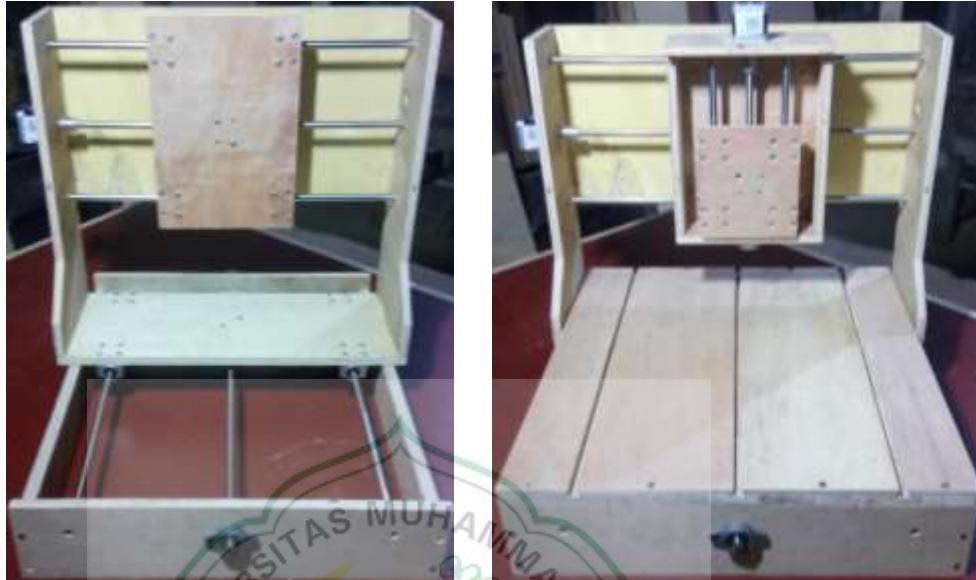
Gambar 3.24 Perakitan frame sumbu x, y dan z
