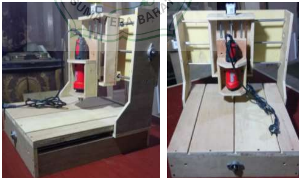
Gambar 3.25 Perakitan frame sumbu x, y, z danudukan bor
