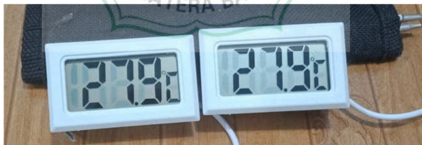
Gambar 3.36. Pengujian akurasi dua unit termometer digital
