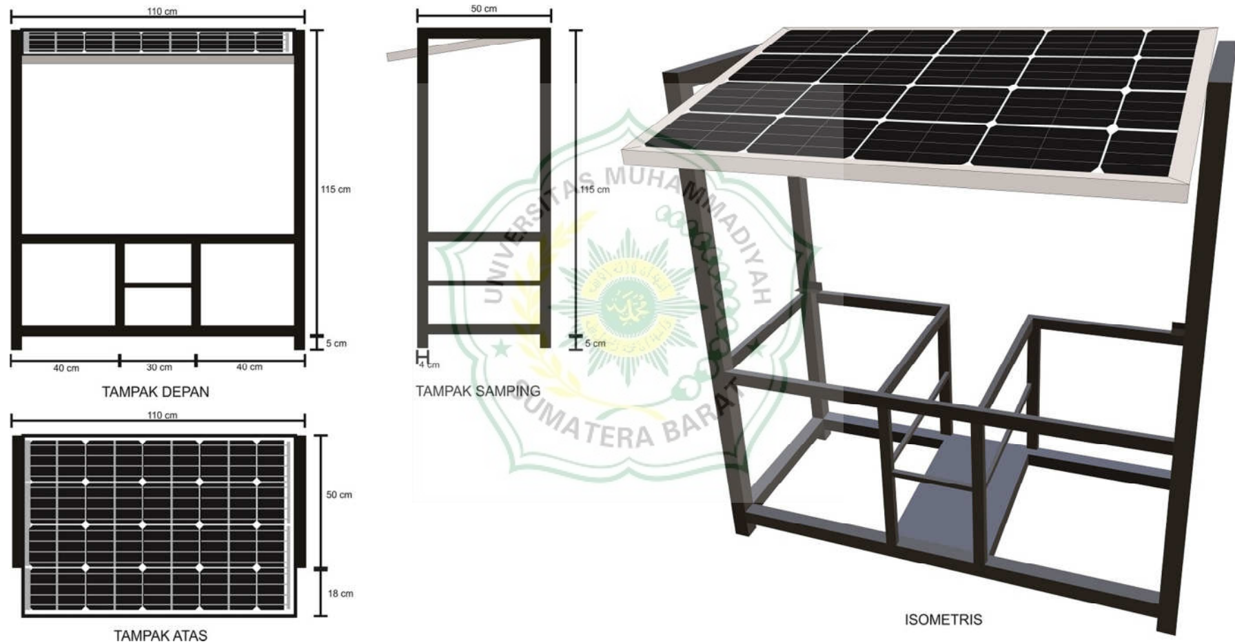
Gambar 3.42. Kontruksi bracket panel surya
