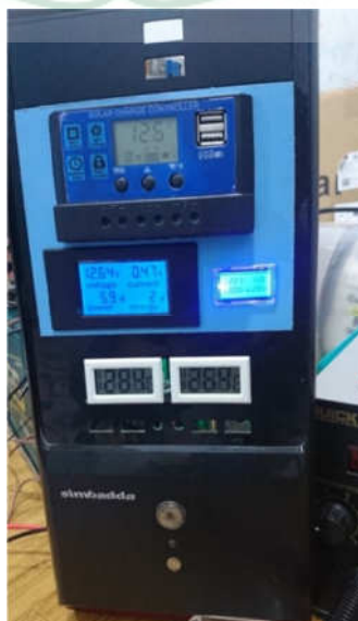
Gambar 4.9. Running test dan pengambilan data melalui kWh DC meter
