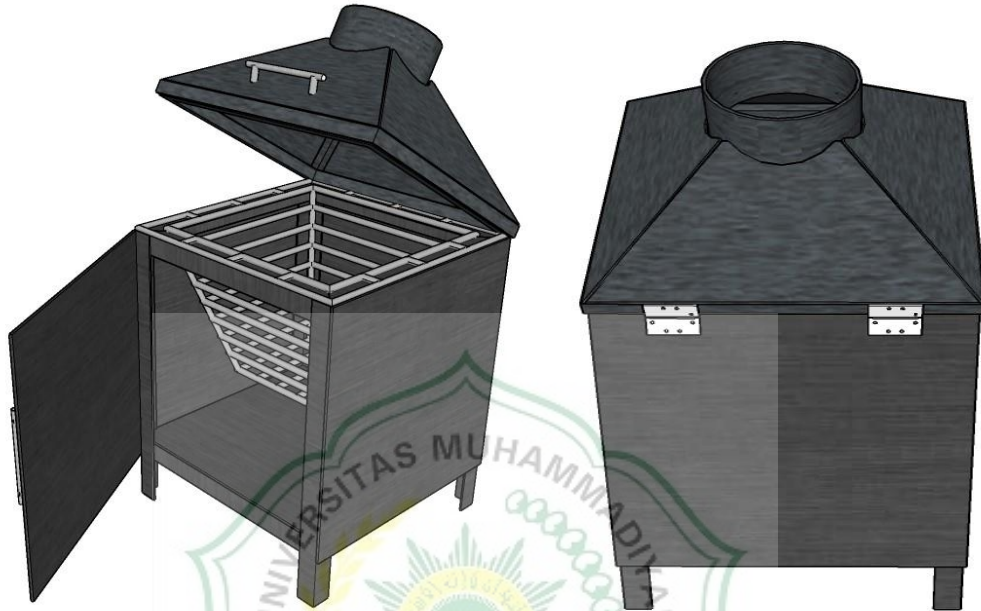
Gambar 3.13. Alat pembakaran setelah dirakit
